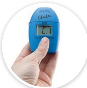
Gerät mit Schwimmbadwasser auf Null setzen
