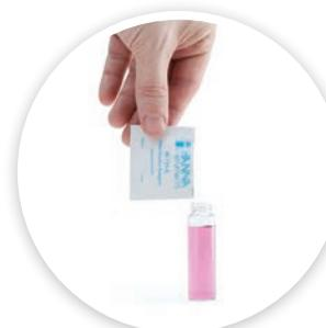
Reagenz zur mit Schwimmbadwasser gefüllten Küvette geben
