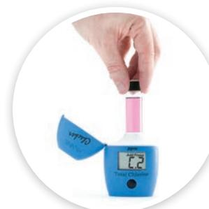
Küvette in den Checker setzen
