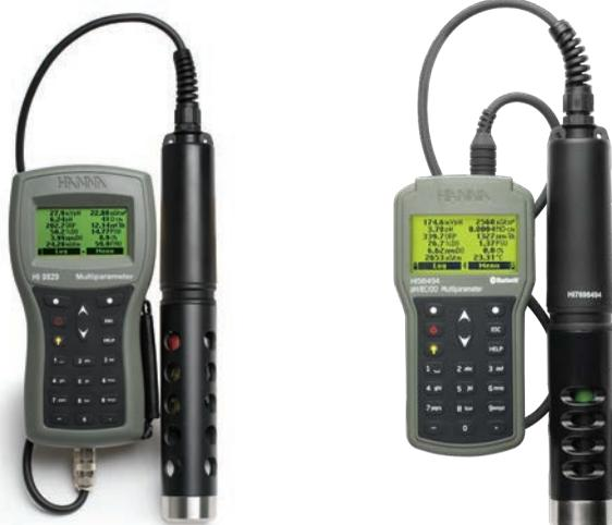
**HI9829** kann bis zu 14 Wasserparameter aufzeichnen. Die mikroprozessor-gesteuerte Multisensor-Sonde unterstützt je nach Konfiguration die Messung wichtiger Parameter inklusive pH-Wert, Redoxpotential, elektrische Leitfähigkeit/TDS, gelösten Sauerstoff, Trübung, Ammonium-, Chlorid- und Nitrationen und Temperatur. Es verfügt zudem optional über eine GPS-Funktion und eine Fast Tracker™-Funktion zur Verknüpfung der Messdaten mit der Position der Probenstelle.
