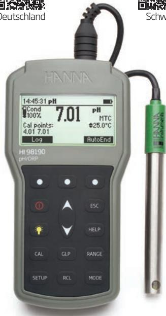
**HI98190** misst den pH-Wert im Bereich von -2 bis +20 mit einer Auflösung von bis zu 3 Nachkommastellen. Mit einer entsprechenden Sonde aus dem umfangreichen Zubehörprogramm ist es auch in der Lage, Redoxpotentiale im Bereich  $\pm 2000$  mV zu bestimmen.
